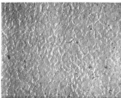
挿図3. 1%塩酸で1分間処理したもの (電顕. \times 1400 )
