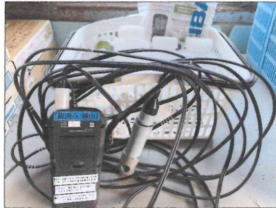
写真 4. 溶存酸素メータの設置状況（横山）
