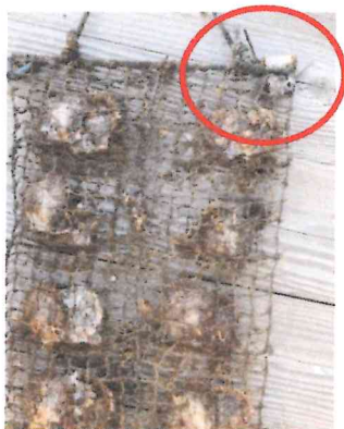
写真 8. 試験貝ネットに付けた水温ロガー
